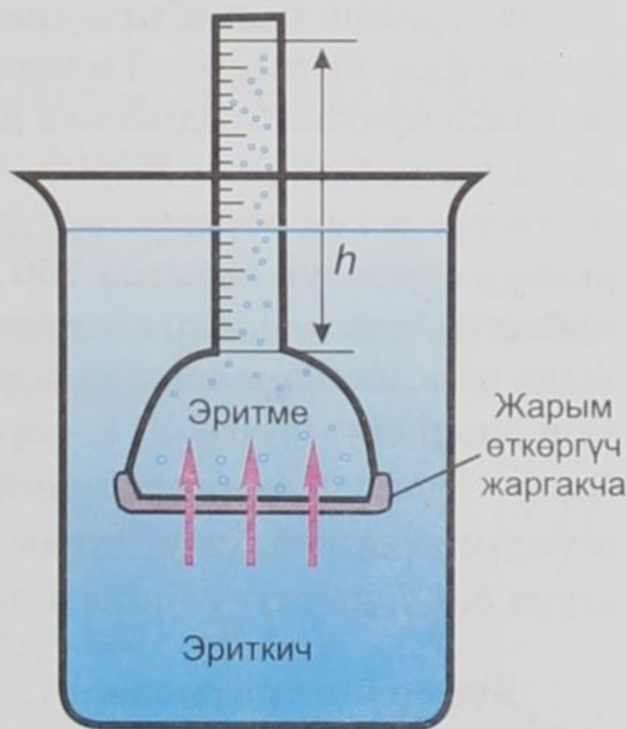
4.6-сүрөт. Осмометрдин иштөө принциби.
